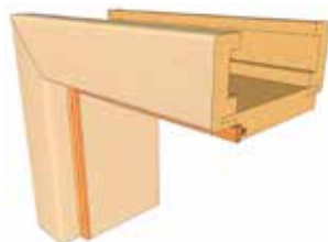
Řez obložkovou zárubní síla zdi od 50 mm, límce 60 mm
