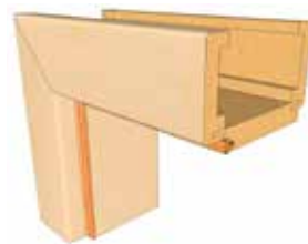
Řez obložkovou zárubní (OKZ) přes původní kovové zárubně síla zdi od 50 mm, límce 80 mm
