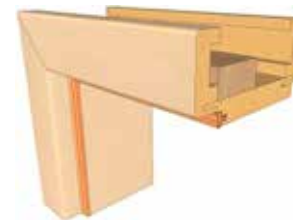
Řez obložkovou zárubní protipožární DPO
